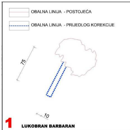
Slika 19. Izgradnja lukobrana na hridi Barbaran
