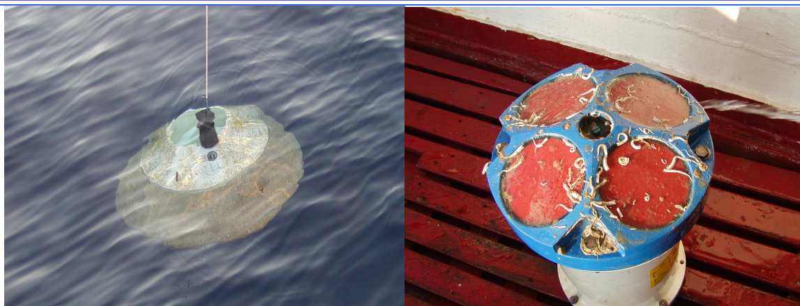
Slika A.3.3.-1. Izgled pomoćne konstrukcije i ADCP strujomjera pomoću kojega su mjerene struje u 19 slojeva širine 1 metra vodenoga stupca
