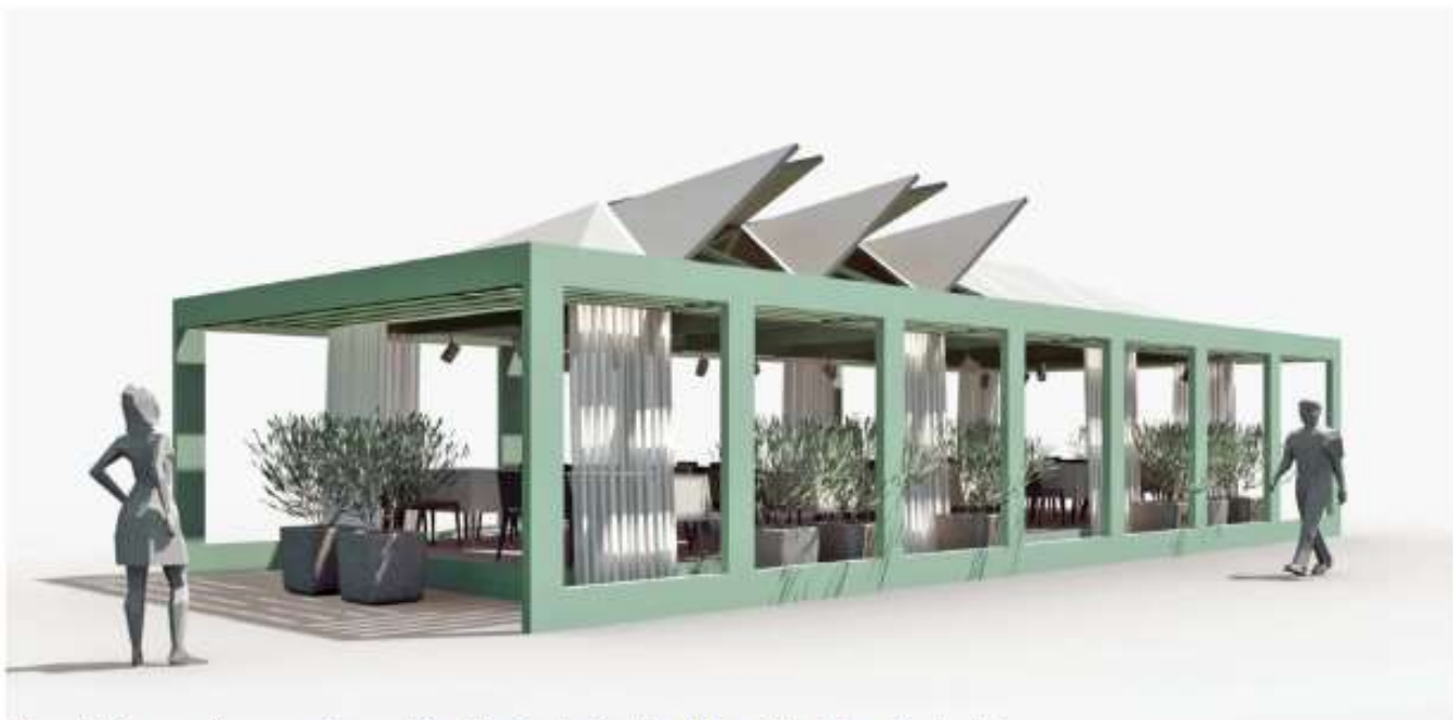
Nezastekljen paviljon zasenčen z brisolejem iz horizontalnih lamel in delno odprto streho.
