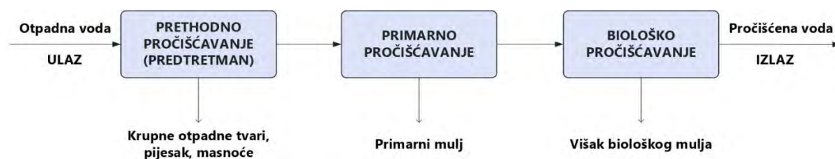
Slika 16. Shematski prikaz postupaka linije pročišćavanje otpadnih voda
