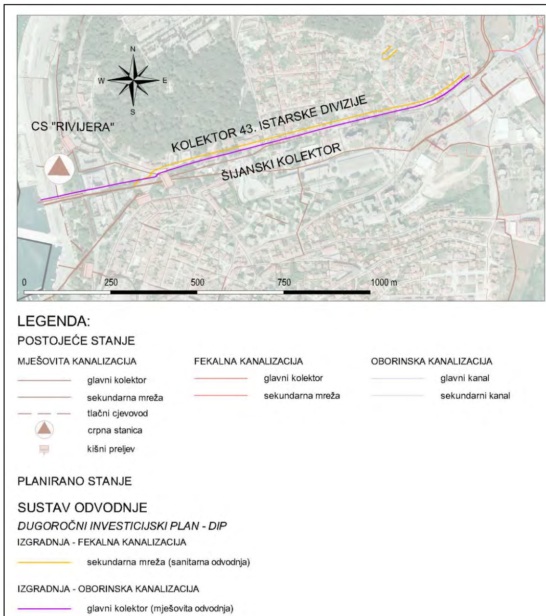
Slika 10. Šijanski kolektor - Izgradnja razdjelne kanalizacije u Ulici 43. divizije
