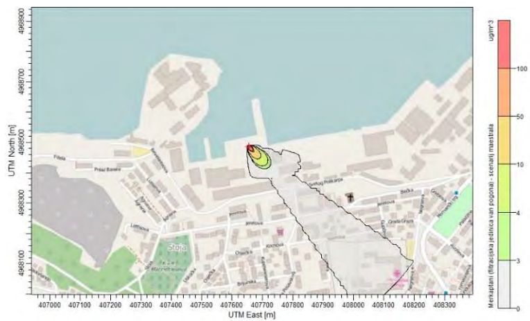
Slika 105. Rezultati analize karakterističnih scenarija, prizemna koncentracija merkaptana za scenarij ispada filtracijske jedinice iz pogona
