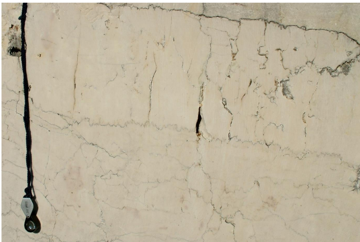
Slika 4.5. Horizontalni i mrežasti tip stilolita, okomito na slojevitost. Foto: Matičec, D. i Fuček, L. (2012.).
