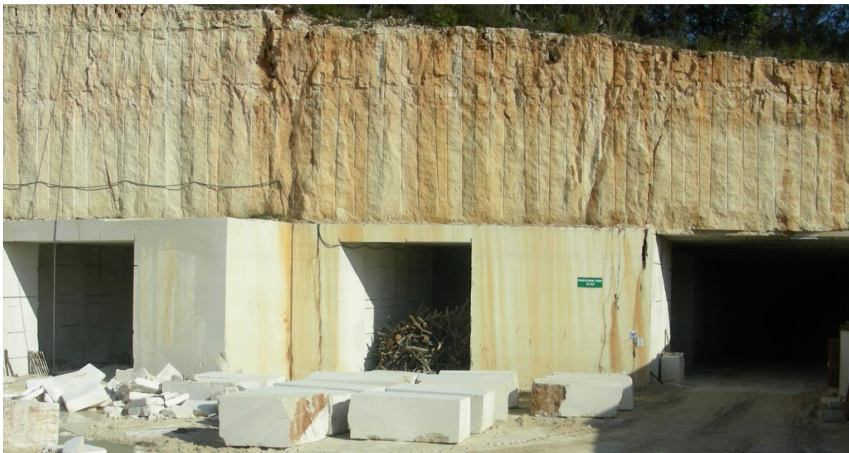
Slika 4.10. Bankovite naslage litostratigrafske jedinice Kanfanar koja se u posljednje vrijeme vadi i pravim rudarskim zahvatima. U krovini su vidljivi tragovi albske emerzije. Foto: Matičec, D. i Fuček, L. (2012.).
