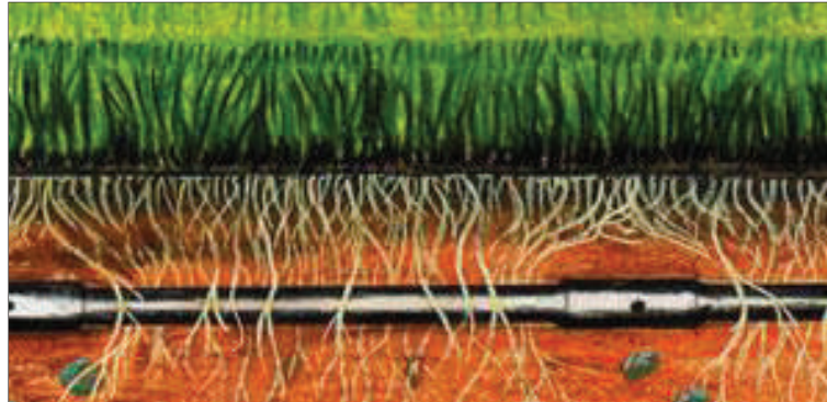
Slika 1.18. Navodnjavanje podzemnim cijevima; supstanca "Treflan" stopira rast korijena na mjestima koja emitiraju vodu i time omogućuju efikasno podzemno navodnjavanje i ulaz korijena u cijev
