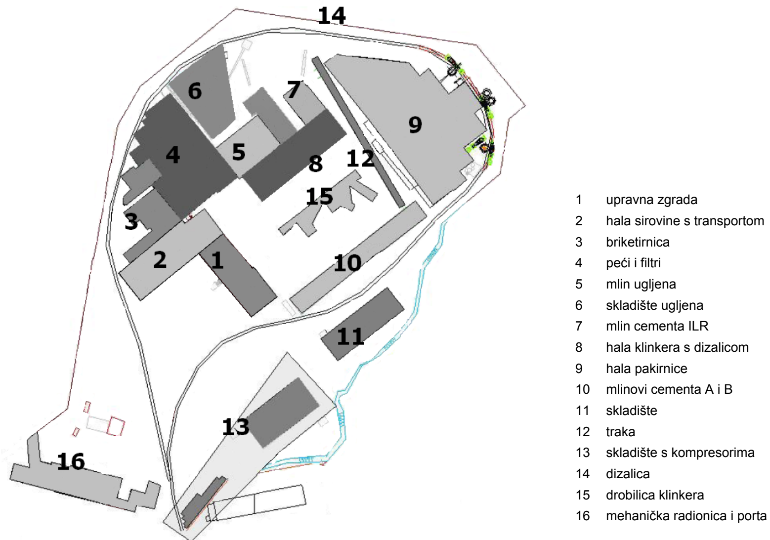
Slika 3 - Prikaz postrojenja prema posebnim tehnološkim dijelovima
