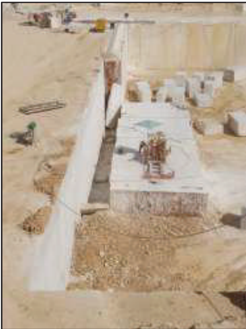
Slika 1.3.1.3. Formiranje blokova lančanom pilom na oborenoj feti i pilom na traktoru
