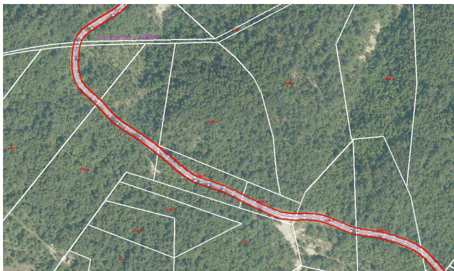
Prikaz 12 Izvod iz GIS baze podataka - prikaz osi i koridora ceste na ortofoto podlozi /izvor: prezentacija Geoprojekt d.d. Opatija u okviru projekta PUT-UP – ISTRE/
