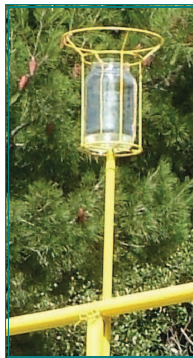
Slika 1b. Postaja za mjerenje ukupne taložne tvari
