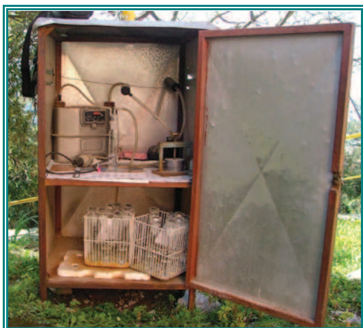
Slika 1a. Postaja za mjerenje SO 2 i dima, ručno posluživanje
