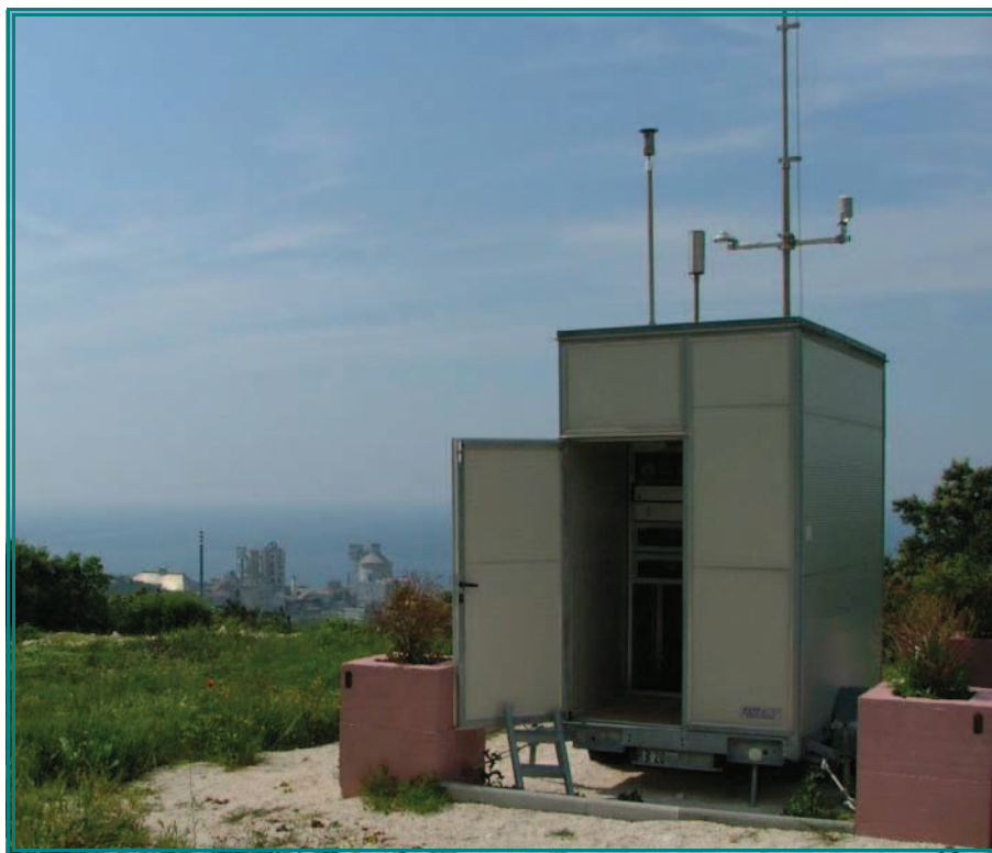
Slika 1c. Automatska mjerna stanica - A.P.Brovinje
